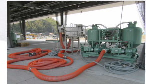
フィッシュポンプ(左)と魚体選別機(右) 水揚げの効率化により鮮度を保つことができる
